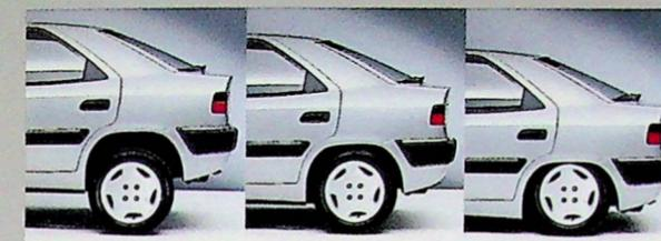
La suspension hydraulique permet de s'adapter à toutes les situations : passage d'obstacles, chargement du coffre, attelage de remorque.
