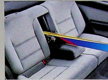
Une trappe dissimulée derrière l'accoudoir arrière permet de loger des objets encombrants.
