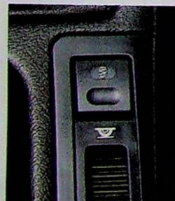
La commande située sur la console centrale permet au conducteur de sélectionner la position de sa suspension.
