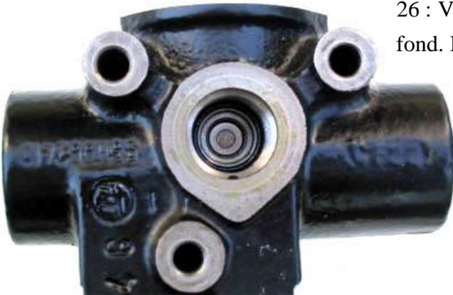
27 : Vue globale des pièces liées au tiroir. Le trou à gauche au niveau du cylindre de la sphère permet de repousser le tiroir en position fermée (grâce à la pression de la sphère) lorsque l'électrovanne n'est plus alimentée.
