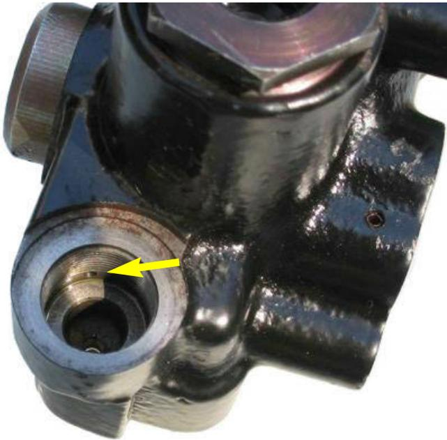
08 : Vue de l'emplacement ou se visse l'électrovanne avec (éclairé) le trou vers le tiroir. Électrovanne en position fermée (non alimentée), ce trou est connecté au retour réservoir; électrovanne ouverte (alimentée) ce trou se retrouve connecté à la haute pression (plus de retour réservoir)
