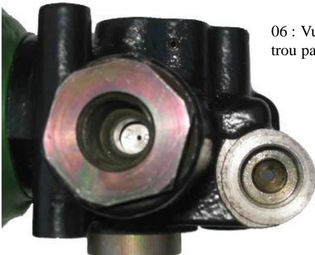
06 : Vue de dessus, électrovanne démontée. On voit, à droite, le trou par lequel arrive la haute pression vers l'électrovanne.
