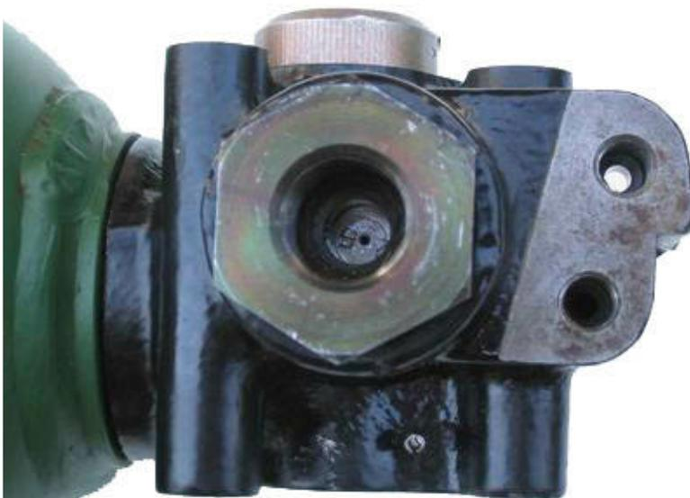
07 : vue de dessous, tuyauteries démontées. On voit le trou par lequel arrive la haute pression (vers l'électrovanne) à droite, et, un peu plus à gauche, celui sur lequel se branche la tuyauterie vers le régulateur de hauteur.
