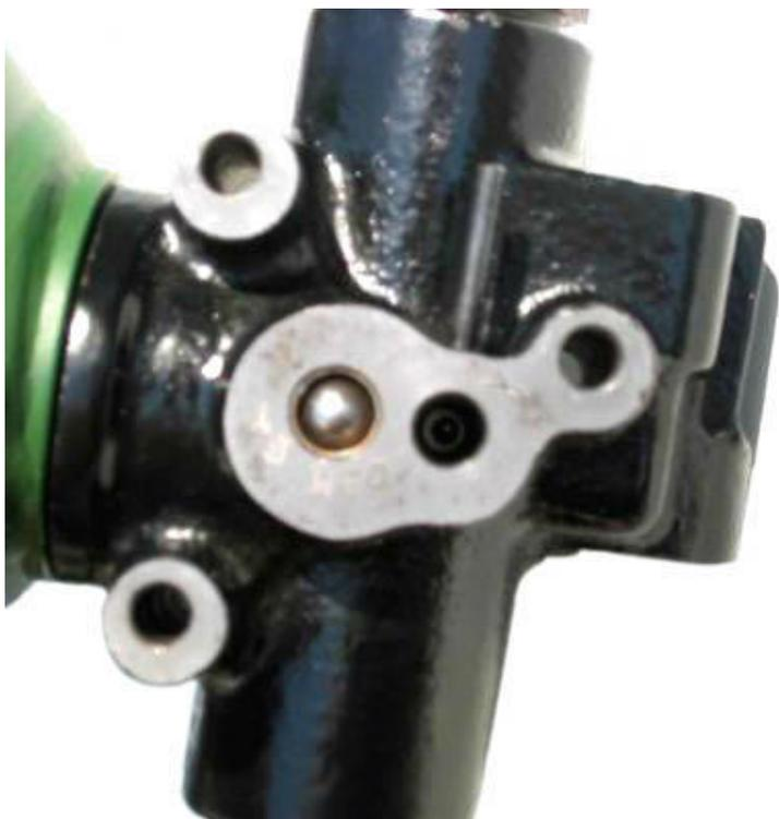
33 : Vue de dessous avec le cylindre dans lequel on retrouve les pièces de la photo précédente (32). On aperçoit (difficilement !) au fond la bille.
