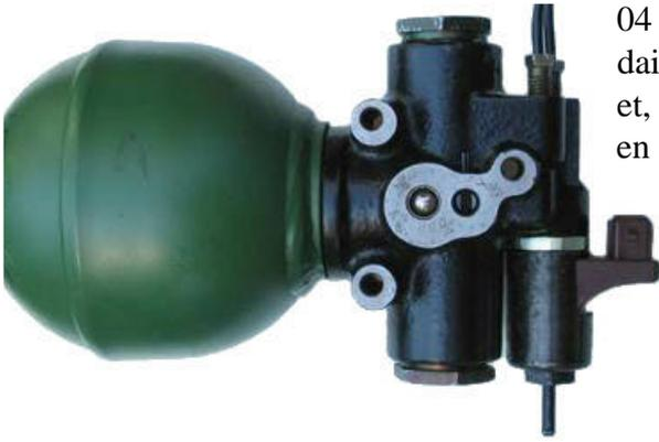
04 : Vue de derrière (cette partie touche une plaque de métal solidaire de la voiture). Les trois trous de fixation sont bien visibles et, au milieu (à gauche), on voit une bille (apparemment enfoncée en force; non démontable) permettant de boucher le cylindre dans lequel coulisse le tiroir (en face du bouchon, visible sur les photos précédentes) A droite de cette bille on aperçoit une goupille maintenant en place dans un cylindre la butée du clapet (dont on aperçoit l'extrémité)
