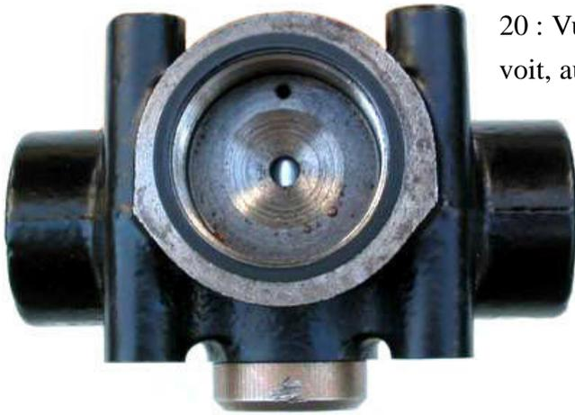
20 : Vue de gauche, le cylindre dans lequel se visse la sphère. On voit, au milieu le trou obstrué par le tiroir ici en position fermée. En haut, on aperçoit un second trou, permettant, grâce à la pression contenue dans la sphère, de repousser le tiroir en position fermée quand la haute pression de commande du tiroir n'est plus envoyée par l'électrovanne (arrêt de l'alimentation électrique de l'électrovanne)
