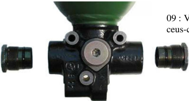
09 : Vue de face, les deux "manchons" démontés. C'est dans ceus-ci que se connectent les tuyaux vers les sphères de suspension droite et gauche.
