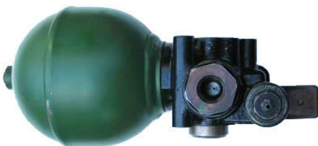
03 : Vue de dessus. On retrouve l’électrovanne à droite avec le trou retournant vers le réservoir. Au milieu se trouve le trou dans lequel se visse la tuyauterie vers la sphère de suspension AV gauche.
