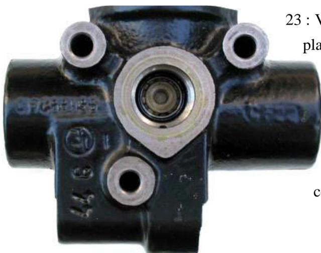
23 : Vue de face, bouchon démonté. On voit une rondelle en plastique (!) au fond (on aperçoit l'extrémité du tiroir derrière). Le trou, visible en bas, est en relation directe avec l'électrovanne (photo 8) et peut donc être mis à la haute pression ou à la pression retour réservoir. Le bouchon transmet la pression à l'extrémité du tiroir (au fond) grâce aux trous visibles sur la photo précédente et à son perçage central (cf photo 24).
