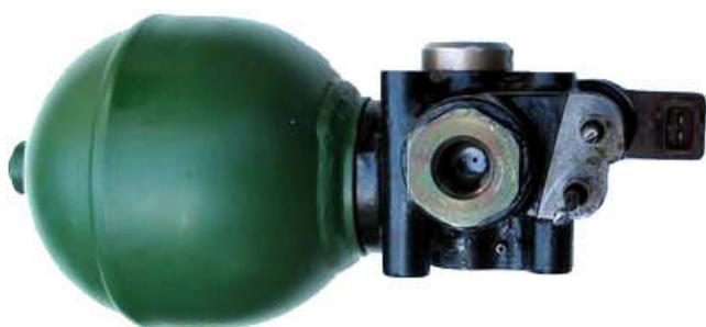
02 : Vue de dessous. On retrouve, en haut, le bouchon du tiroir et, devant, le manchon dans lequel se visse la tuyauterie vers la sphère de suspension AV droite. A droite on voit le connecteur électrique de l’électrovanne et les deux tuyauteries “régulateur de hauteur” et “haute pression”. On aperçoit également, en bas au milieu, la queue de la goupille retenant la butée du clapet.
