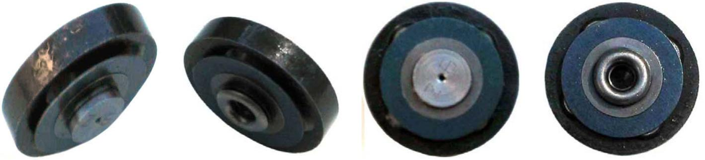
14, 15, 16, 17 : Vues de la pastille amortisseur démontée Ces pastilles amortisseur permettent de limiter le transfert de liquide gauche-droite en mode souple et donc de limiter la prise de roulis.
