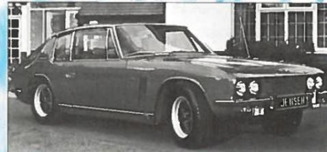
La Jensen "Interceptor FF" : système Maxaret, transmission intégrale, système Ferguson, moteur Chrysler V8 hémisphérique 7 litres, 225 km/h.
