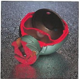
L'accumulateur de freinage intervient lors de défaillance de la source principale. Il restitue du liquide sous-pression pour permettre l'alimentation des étriers de frein avant.
