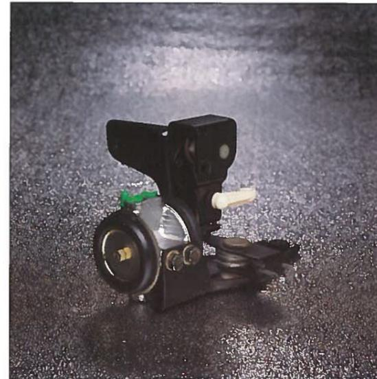
fonctionnement plus loin). Les correcteurs sont reliés à la barre anti-roulis par l'intermédiaire d'une tige métallique souple (tige de torsion). En cas de débattement de la suspension, la barre anti-roulis tourne et entraîne la tige. Celle-ci vient tirer ou pousser sur le tiroir du correcteur. La souplesse de la tige permet de donner le temps nécessaire au fonctionnement normal du Dash-Pot (5 secondes).
