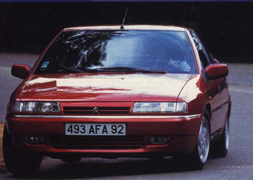
Voie élargie et remodelage de la prise d'air inférieure pour la Xantia. La suspension Activa est désormais disponible avec un nouveau moteur deux litres turbo de 150 chevaux.
