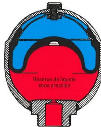
2/ Lorsque le liquide sort de l'accumulateur (pour répondre à la demande de liquide sous-pression due au fonctionnement d'un organe hydraulique), le volume qu'il occupait diminue, ainsi que la pression. Le gaz comprimé se détend, augmente de volume et compense ainsi ces variations jusqu'à ce que la membrane atteigne une nouvelle position d'équilibre.
